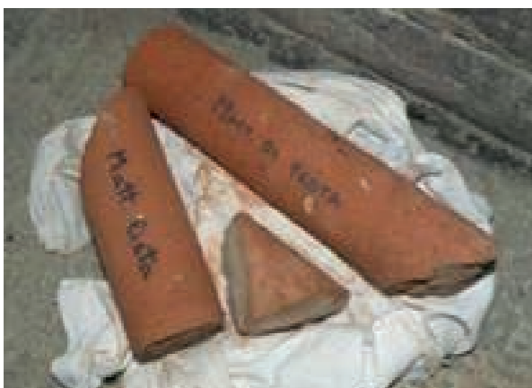
7. Campioni di laterizio estratti dalla muratura.
