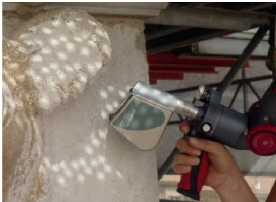
2. Fase di acquisizione di un elemento dell'apparato scultoreo-decorativo della Torre con lo strumento di misura ad altissima risoluzione.
