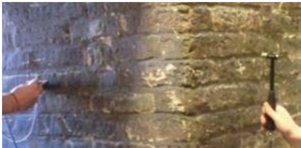
5. Martello sonico e accelerometro.
