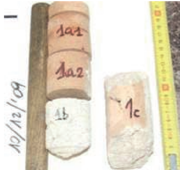
8. Preparazione in laboratorio dei campioni di laterizio e di malta per prove meccaniche.
