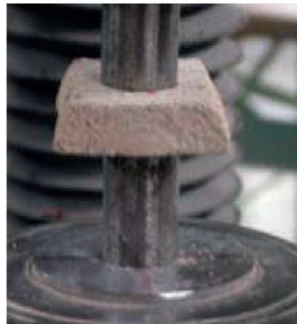
9. Esecuzione di prova di compressione su un campione di malta prelevato dalla torre.
