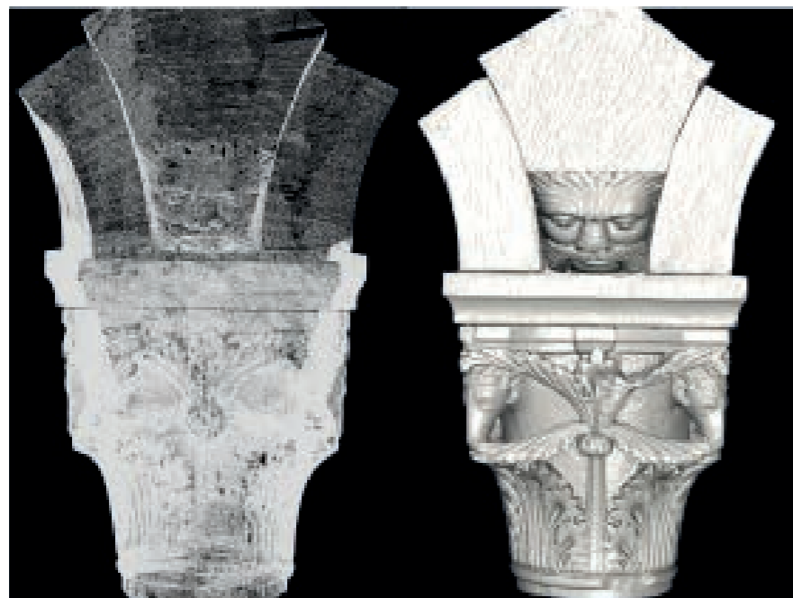
3. Elaborazione dei dati tridimensionali ad altissima risoluzione acquisiti: dalla "nuvola di punti" di partenza al modello a superfici finale.
