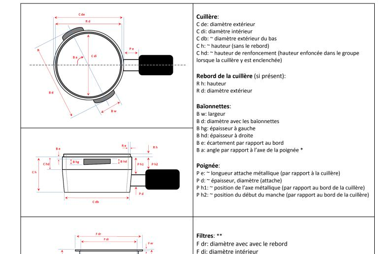
F de: diamètre extérieur F db: ~ diamètre du bas F er: épaisseur du rebord
