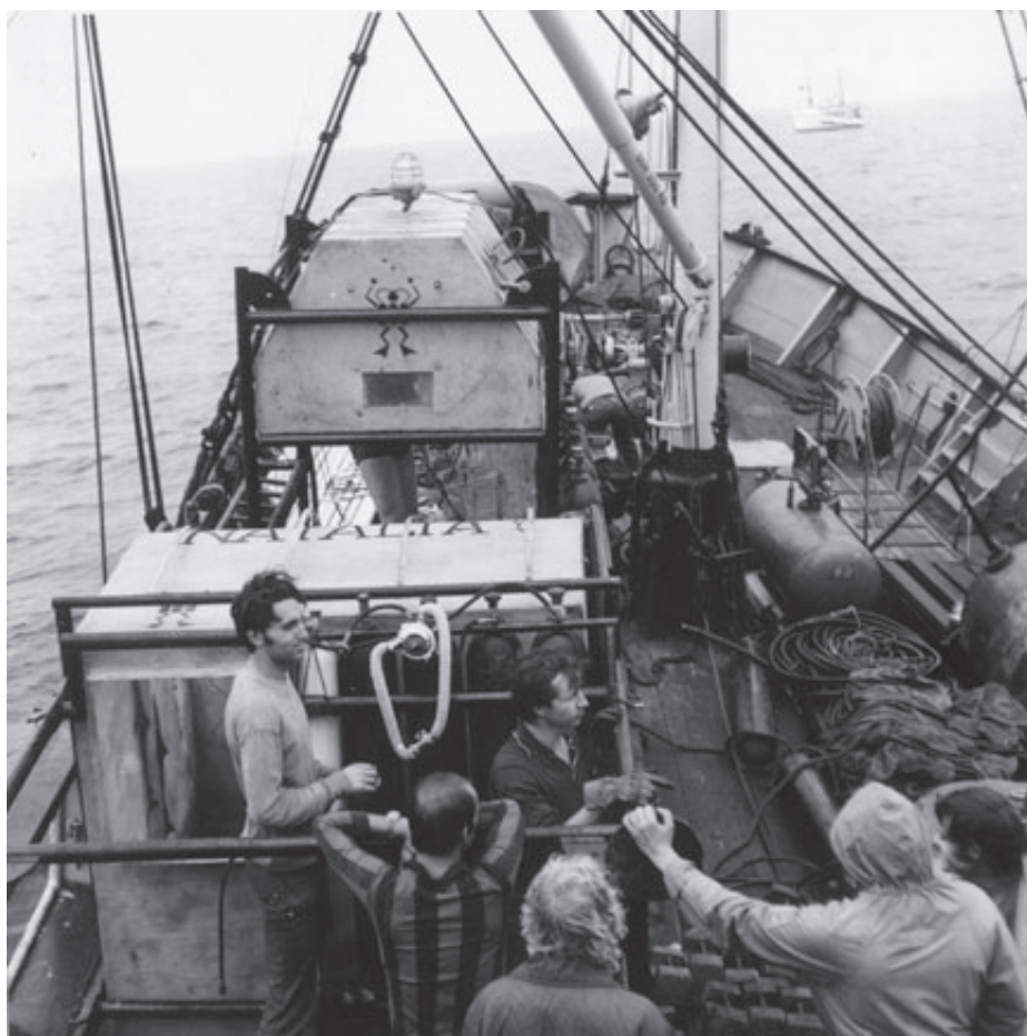
Zanurzalna komora dekompresyjna „Natalia” sfotografowana na pokładzie „Konstelacji”. W trakcie badań na „Gustloffie” była ona zanurzona na głębokości 6 metrów, z kolei dzwon nurkowy „Ania” został zaczepony do wraku na głębokości 25 metrów
