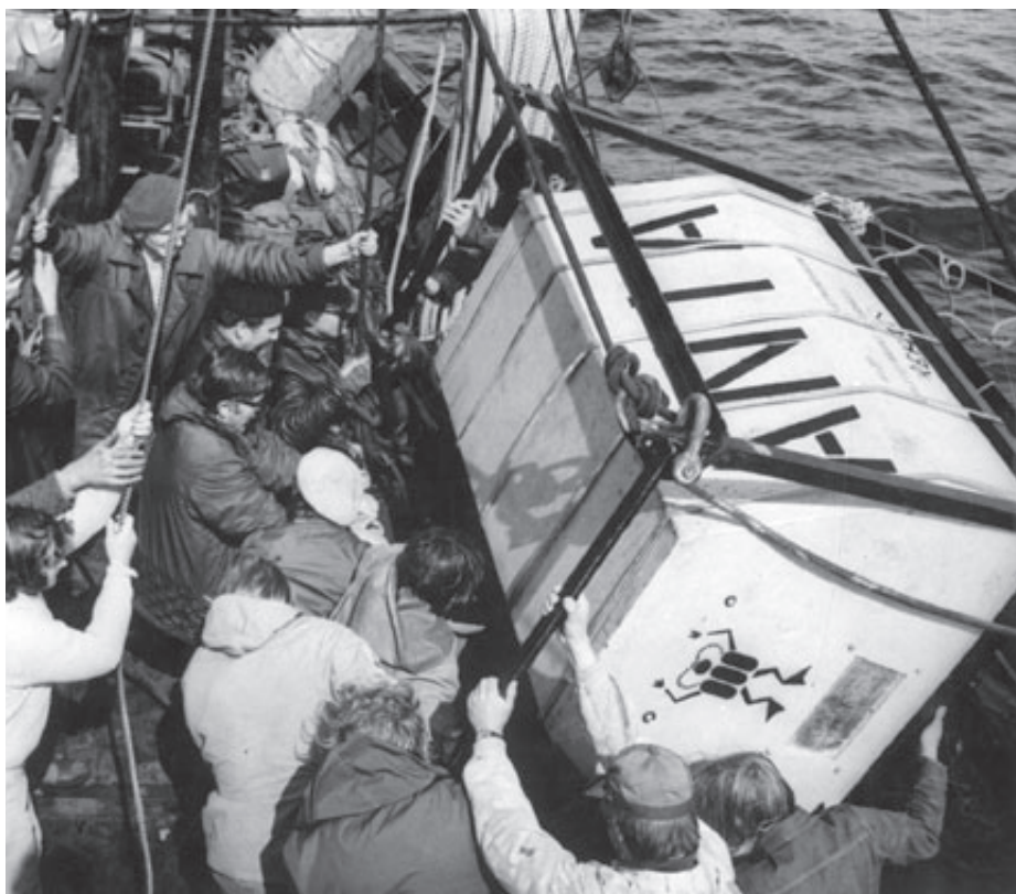
Przed wyprawą na wrak „Gustloff” wykonano generalną próbę dzwonu nurkowego „Ania”. Została ona przeprowadzona pod Jastarnią z kutra rybackiego „Rekin”, a dzwon opuszczono na głębokość 34 metrów
